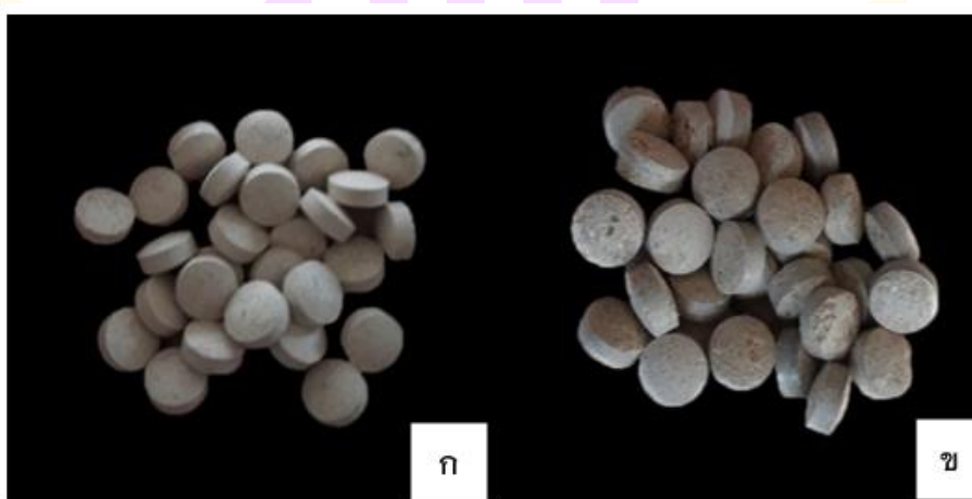
ภาพ 4 ลักษณะของเม็ดปุ๋ยชีวภาพหลังการขึ้นรูปเป็นเม็ด
