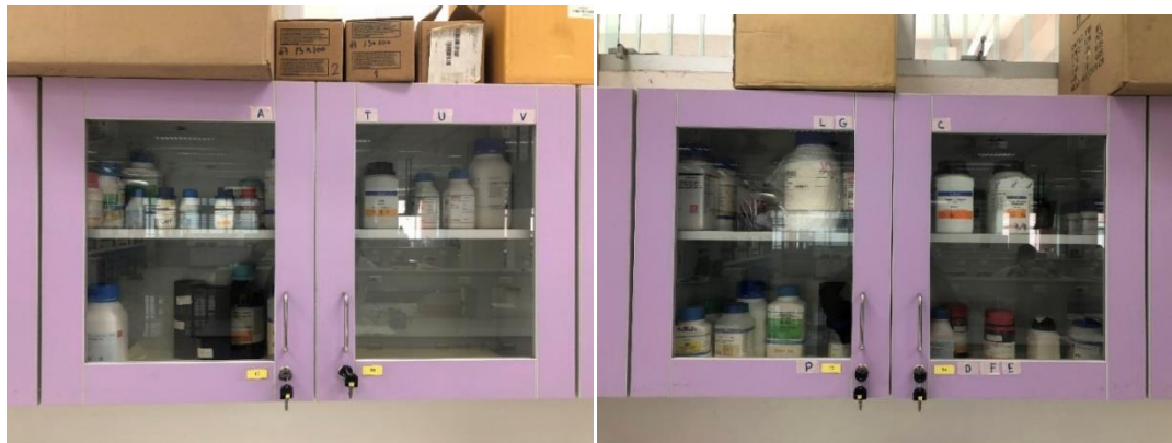
รูปภาพที่ 1: แสดงการจัดเก็บสารเคมี โดยไม่มีรายชื่อสารเคมีหน้าตู้และชื่อผู้รับผิดชอบ ตู้เก็บสารเคมี
