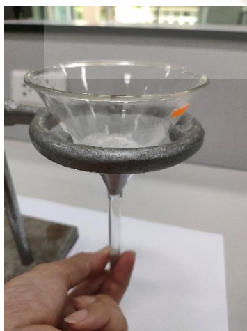
รูปที่ 17 อุปกรณ์หาค่าการไหล (flowability) ของอนุภาค
