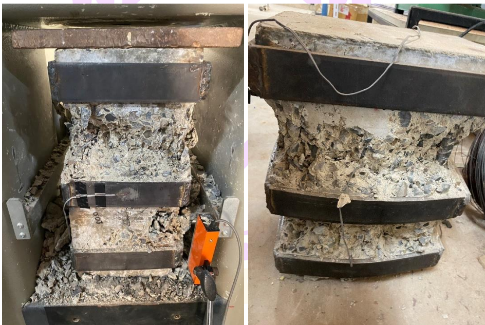
ภาพ 40 ลักษณะการวิบัติของเสา C1
