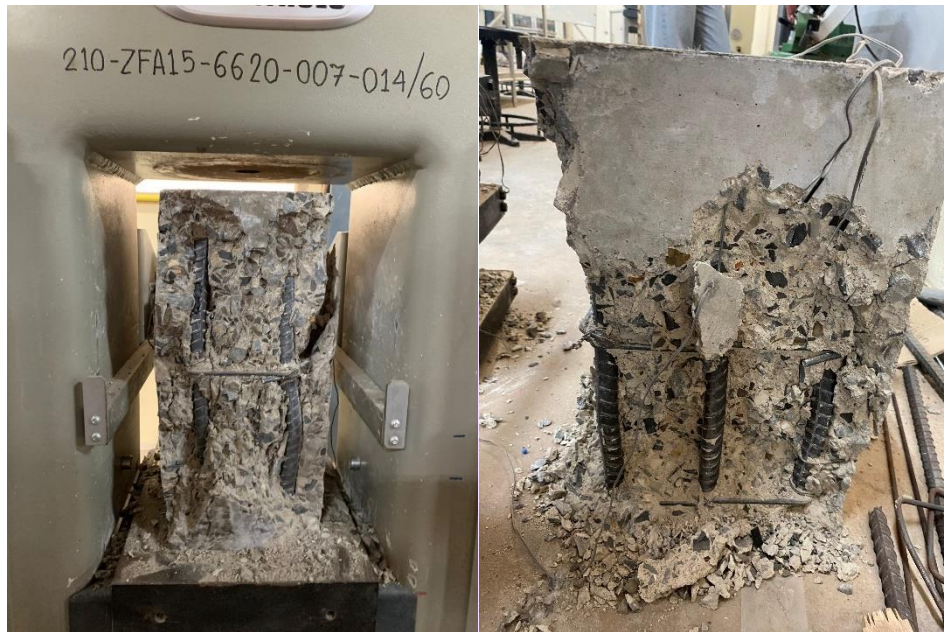
ภาพ 39 ลักษณะการวิบัติของเสา C0
