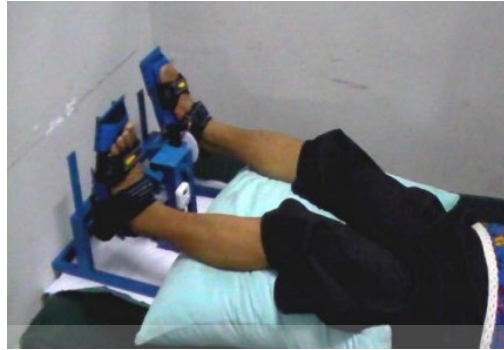
รูปที่ 3 ลักษณะการใช้งานอุปกรณ์เครื่องช่วยขยับข้อเท้าต้นแบบ (3)
