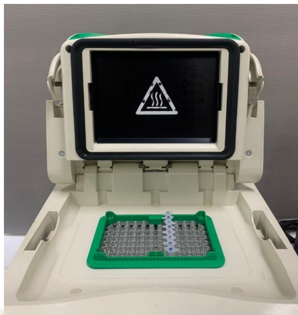
ภาพที่ 4.2.6 แสดงบริเวณฝาเครื่องที่เป็นบริเวณที่มีความร้อนสูงต้องระวังเมื่อนำหลอด PCR ออกจากเครื่อง
