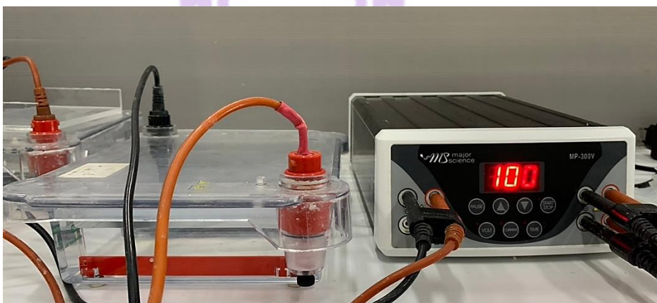
ภาพที่ 3.5.12 กล่องบรรจุบัฟเฟอร์ที่มีขั้วไฟฟ้า (gel chamber) ที่ต่อกับเครื่องกำเนิดไฟฟ้า (power supply)
