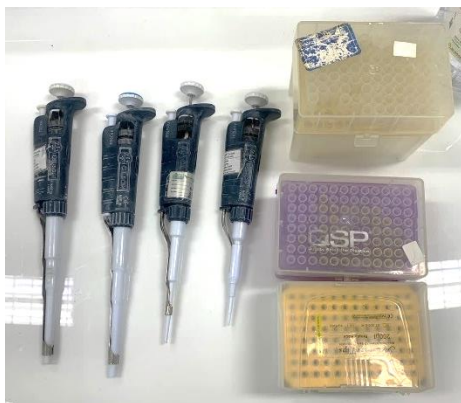
ภาพที่ 3.5.1 เครื่องดูดจ่ายสารละลายอัตโนมัติ (auto pipette) และปิเปตทิป (tip)
