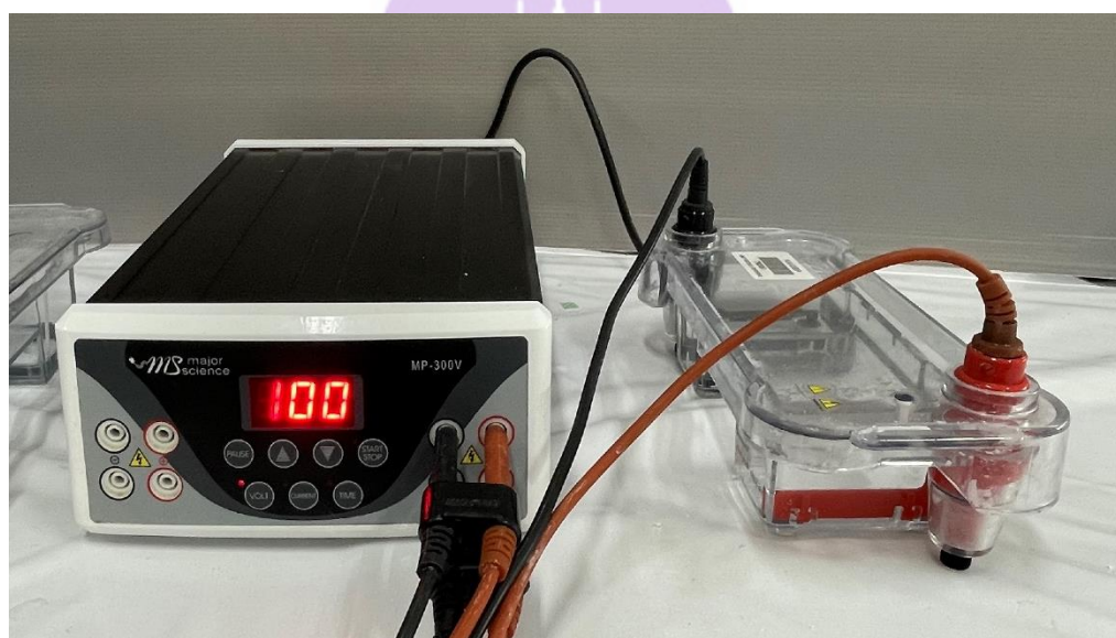
ภาพที่ 3.4.5 แสดงรูปเครื่องกำเนิดไฟฟ้าที่ต่อกับกล่องบรรจุบัฟเฟอร์ที่มีขั้วไฟฟ้า (gel chamber)
