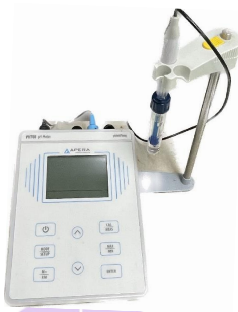
ภาพที่ 3.5.3 เครื่องวัดความเป็นกรด-ด่าง (pH meter)
