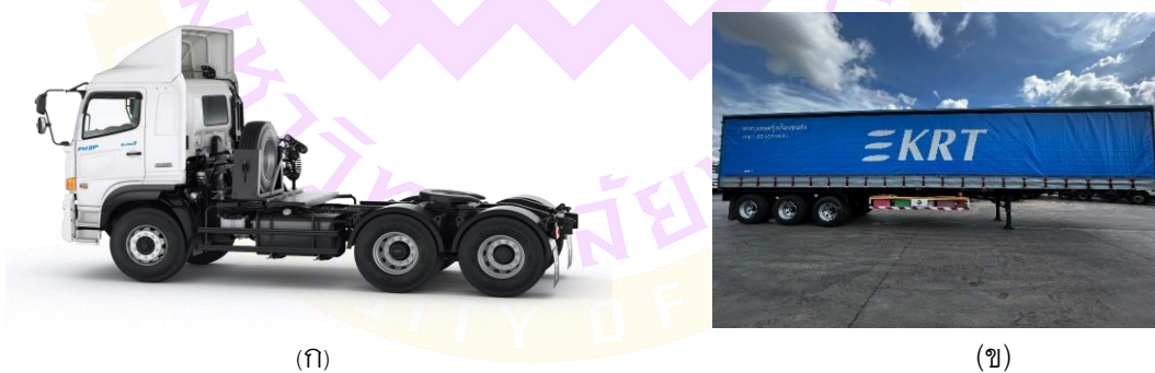
ภาพ 1 แสดง (ก) หัวลาก และ (ข) รถกึ่งพ่วง
