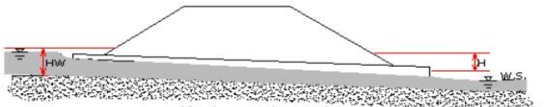
(d) Culvert Not Flowing Full
