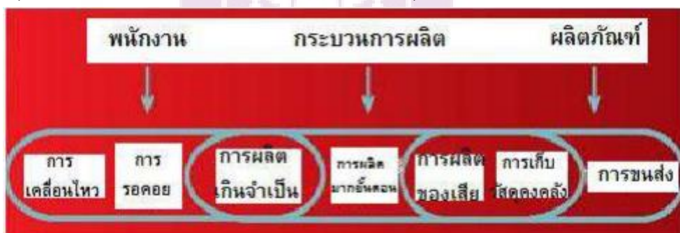
ภาพที่ 3 แสดงความสัมพันธ์ระหว่างพนักงาน กระบวนการผลิต ผลิตภัณฑ์และความสูญเสีย 7 ประการ
