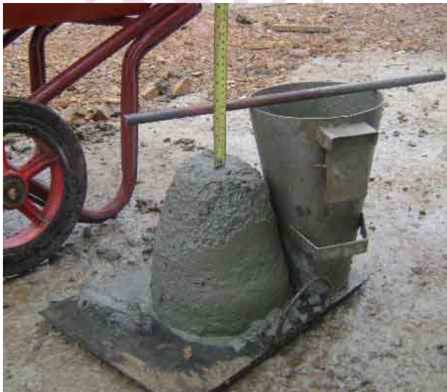
ภาพ 5 แสดงตัวอย่างการทดสอบค่ายุบตัวของคอนกรีต
