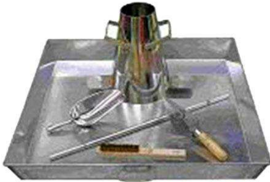
ภาพ 4 แสดงอุปกรณ์ทดสอบค่ายุบตัวของคอนกรีต
