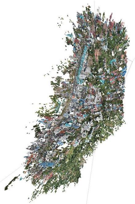
ภาพ 32 ข้อมูลกลุ่มจุดภาพ 3 มิติ (Point Cloud) จากการประมวลผลแบบใช้จุดควบคุมภาคพื้นดิน
