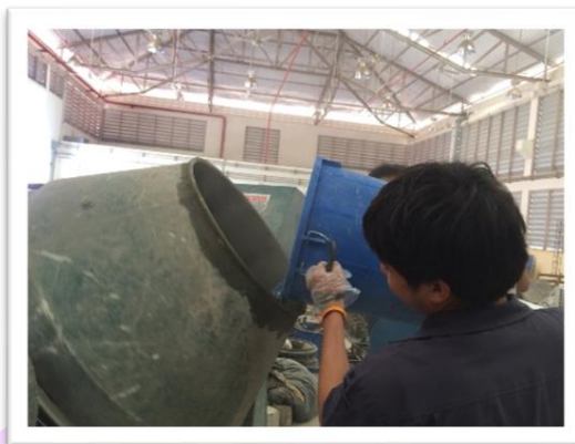
ภาพ 27 ขั้นตอนเติมน้ำสะอาดเข้าเครื่องผสม
