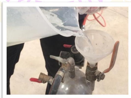
ภาพ 29 ขั้นตอน เทน้ำยาโฟมใส่เครื่องทำโฟม
