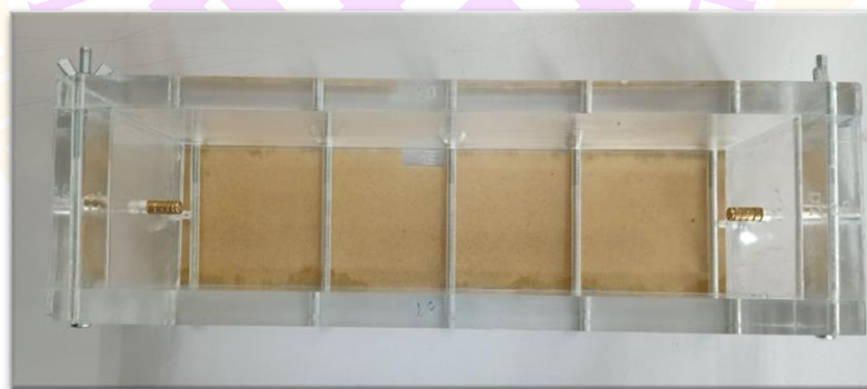
ภาพ 18 แบบหล่อตัวอย่างการทดสอบหดตัวขนาด 7.5x7.5x28.5 เซนติเมตร
