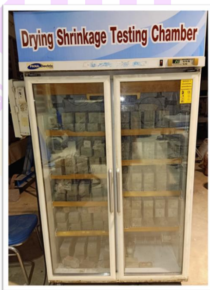
ภาพ 24 ตู้ควบคุมอุณหภูมิและความชื้น (Drying Shrinkage Testing Chamber)
