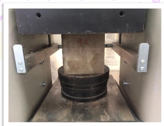
ภาพ 31 การทดสอบกำลังรับแรงอัด
