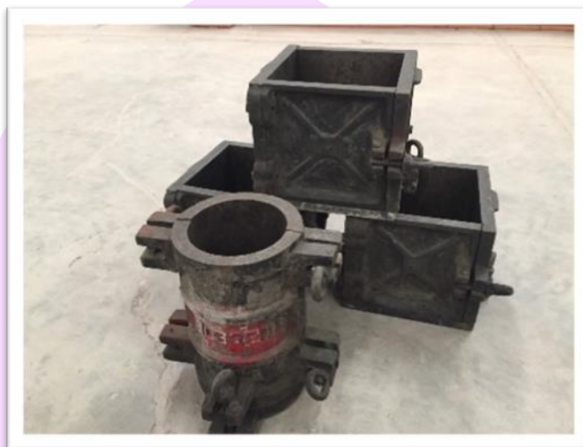
ภาพ 17 แบบหล่อตัวอย่างการทดสอบกำลังอัดทรงลูกบาศก์ขนาด 15x15x15 เซนติเมตร และแบบหล่อตัวอย่างการทดสอบนำความร้อนทรงกระบอกขนาด \varnothing 10x20 เซนติเมตร
