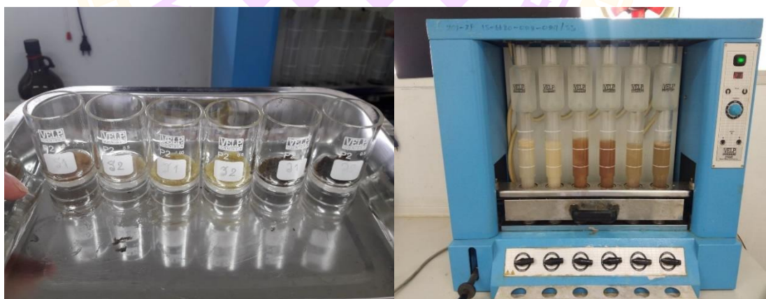
ภาพ 14 เตรียมถ้วยวัตถุดิบการวิเคราะห์หาค่าเยื่อใย (ซ้าย). ทำการวิเคราะห์หาค่าเยื่อใยในเครื่องวิเคราะห์ไขมัน (ขวา)
