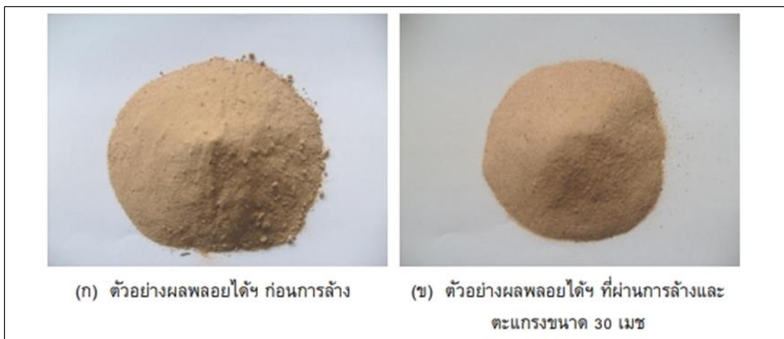
ภาพ 20 ผลพลอยได้จากกระบวนการดูดทรายก่อนและหลังทำการชะล้าง
