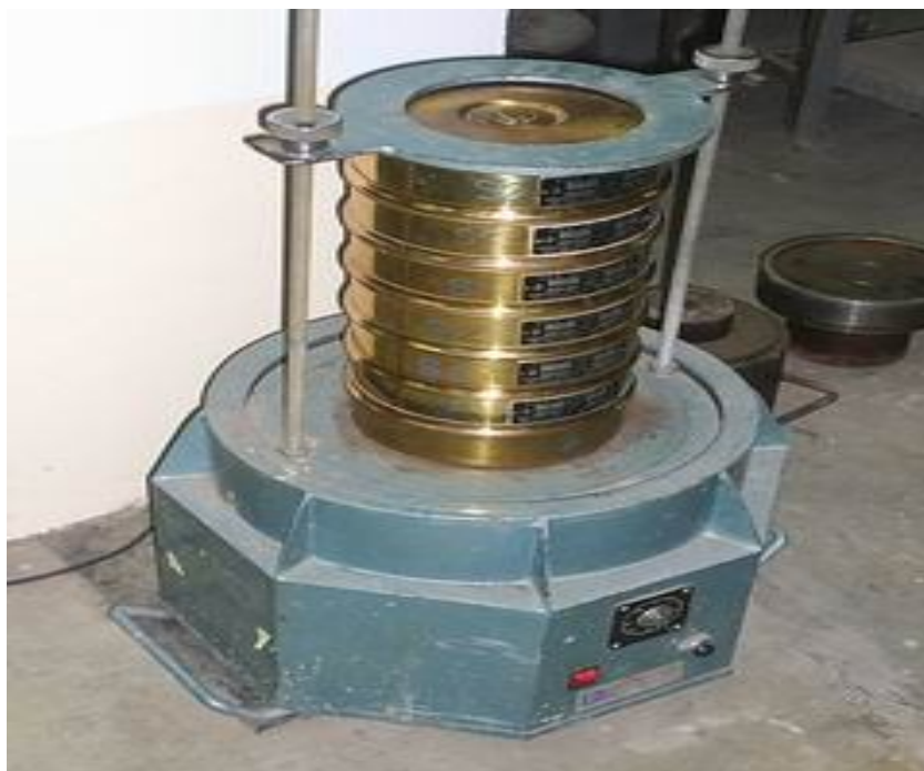
ภาพ 7 แสดงเครื่องทดสอบการหาขนาดคละของดิน
