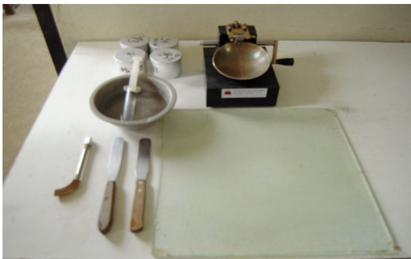
ภาพ 8 แสดงเครื่องทดสอบหาขีดจำกัดเหลว
