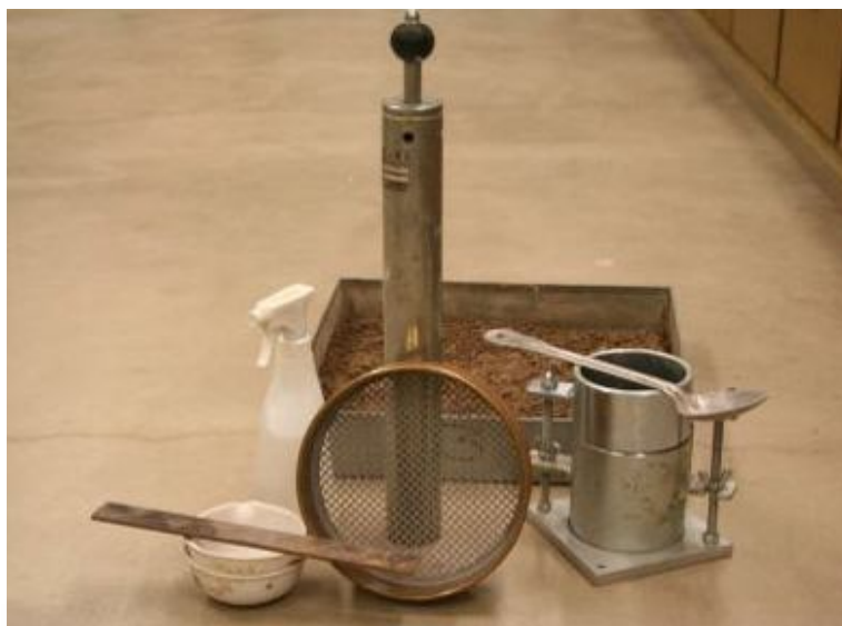
ภาพ 9 แสดงเครื่องทดสอบบดอัดดิน
