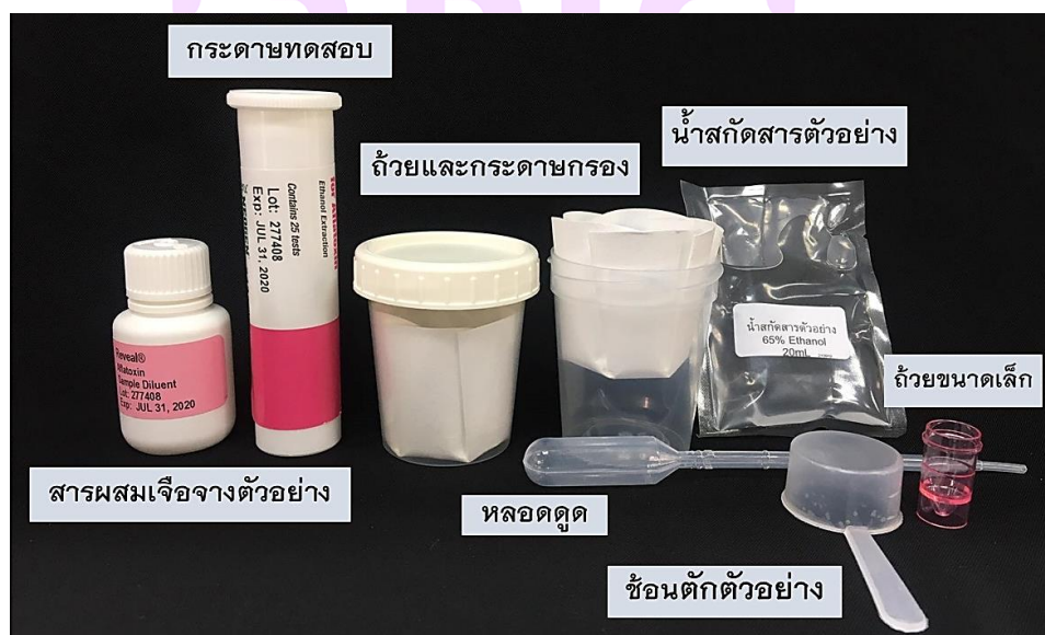
ภาพ 17 แสดงอุปกรณ์ชุดทดสอบสารพิษอะฟลาทอกซิน
