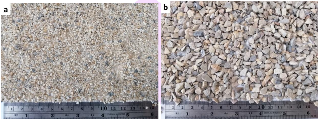
ภาพ 26 วัสดุคัดเลือกคันทาง (a) ทรายที่ผ่านตะแกรงเบอร์ #8 ค้างเบอร์ #30, (b) หินที่ผ่านตะแกรงเบอร์ #4 ค้างเบอร์ #16
