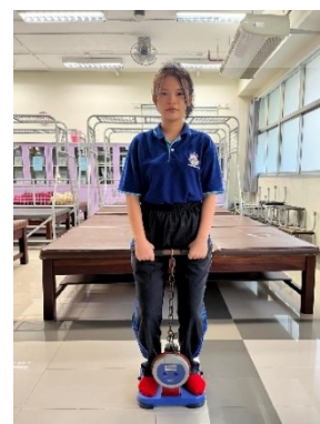
รูปภาพที่ 15 วัดความแข็งแรงของกล้ามเนื้อขาและหลัง (ขั้นตอนที่ 4 ผู้รับการทดสอบเงยหน้าตามองตรง หลังตรง ย่อเข้า)
