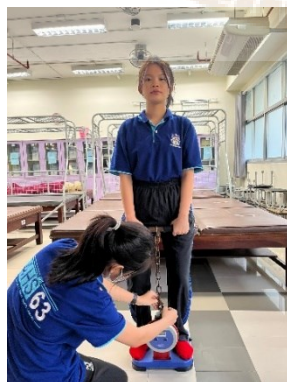
รูปภาพที่ 14 วัดความแข็งแรงของกล้ามเนื้อขาและหลัง (ขั้นตอนที่ 3 ผู้ทดสอบนำโซ่คล้องกับตะขอที่ตัวไดนาโมมิเตอร์)
