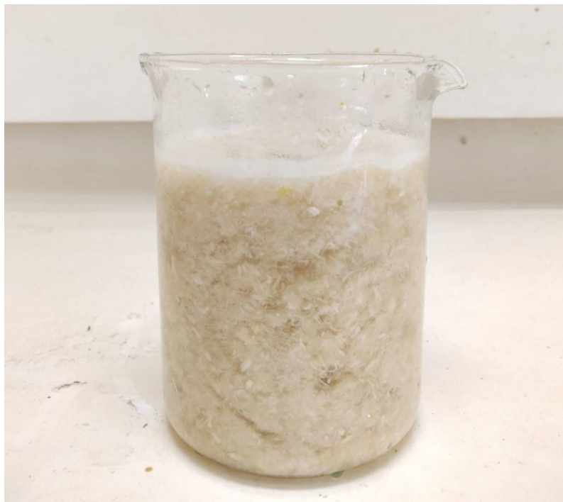
ภาพ 30 กระบวนการฟอกสีเส้นใยเซลลูโลสจากลำต้นเทียนมกล้วยน้ำว้า
