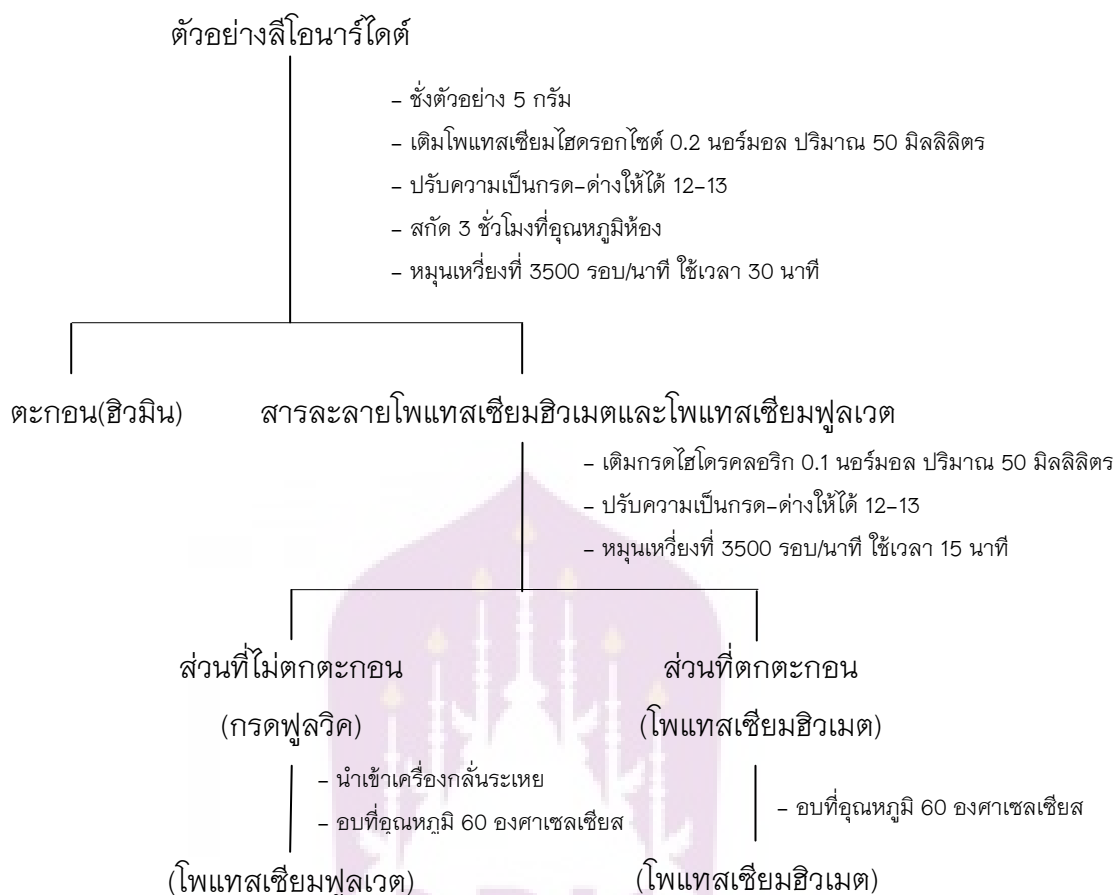
ภาพ 2 แสดงขั้นตอนในการแยกโพแทสเซียมชีวเมต โพแทสเซียมชีวมีน โพแทสเซียมฟูลเวต จากตัวอย่างลีโอนาร์โดต์โดยใช้สารละลายไฮดรอกไซด์
