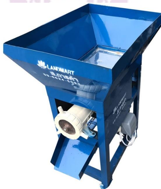
ภาพ 4 เครื่องอัดเม็ดปุ๋ยแบบมินเซอร์
