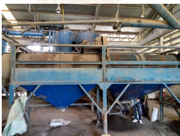
ภาพ 12 การคัดขนาดเม็ดปุ๋ยอินทรีย์ และการบรรจุกระสอบ
