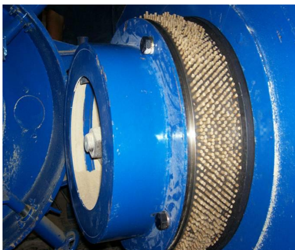
ภาพ 5 เครื่องอัดเม็ดปุ๋ยแบบอัดเม็ดออกด้านข้าง (pellet mill)
