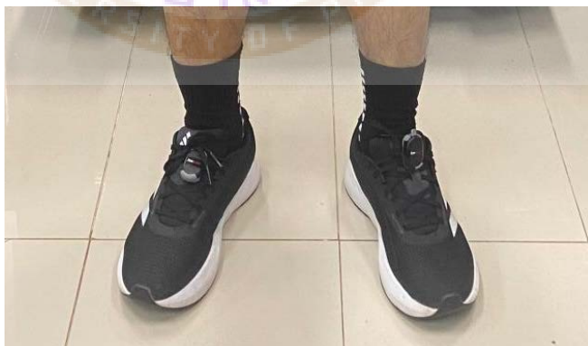
รูปที่ 7 แสดงการติดตั้งอุปกรณ์ Run Scribe
