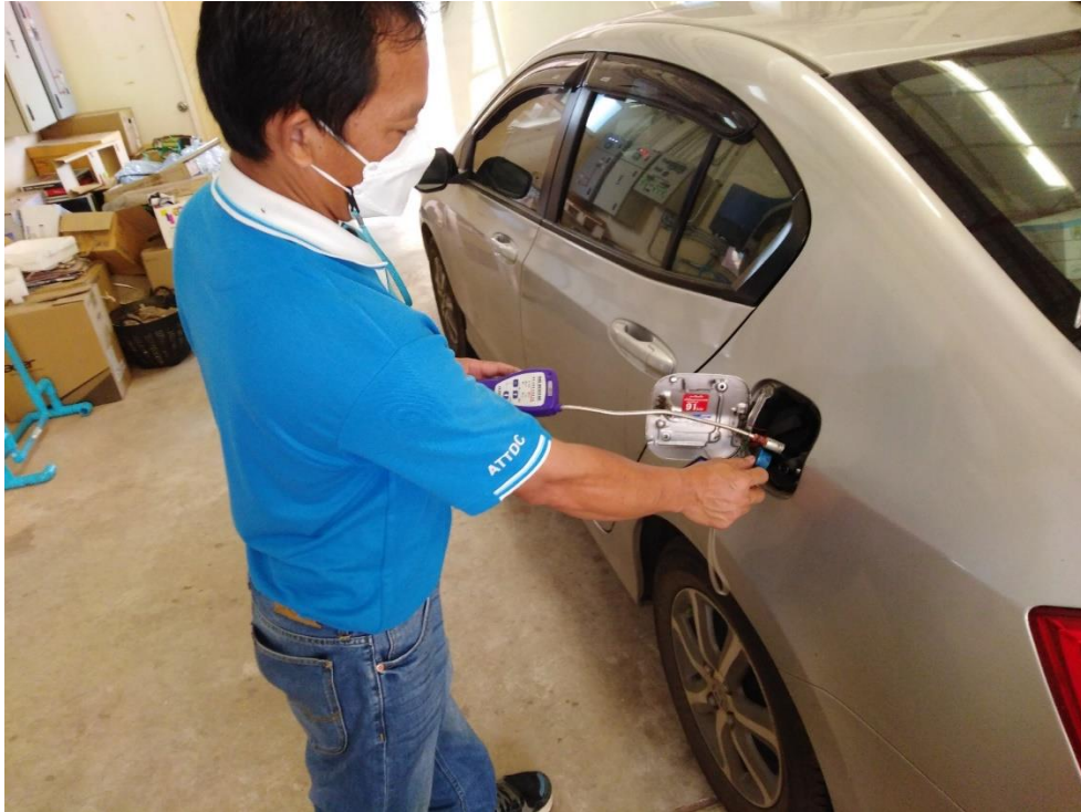
รูป 7 แสดงตรวจสอบการติดตั้งหัวรับเติมก๊าซ
