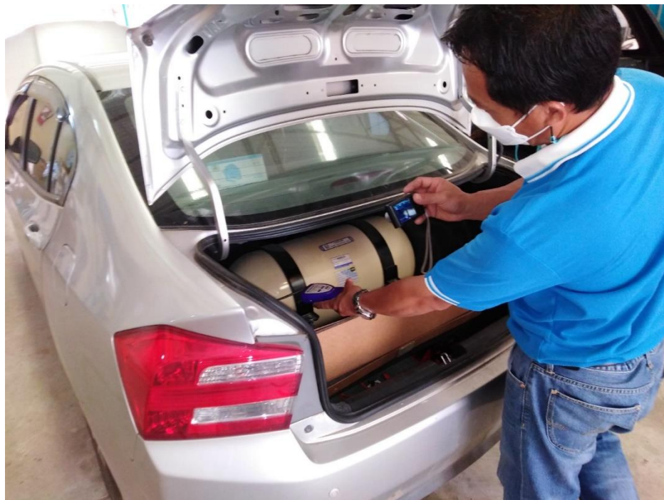
รูป 6 แสดงตรวจสอบถังก๊าซ
