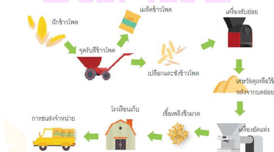
ภาพ 31 แสดงกระบวนการผลิตเชื้อเพลิงอัดแท่ง (wood pellet)
