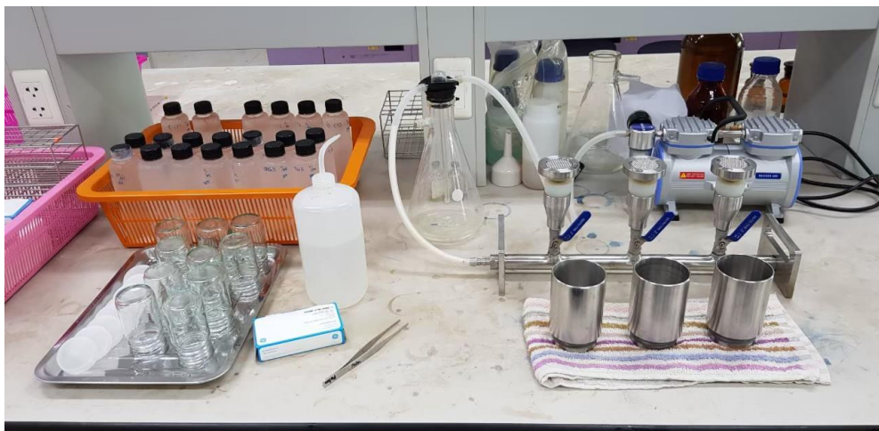
ภาพ 38 อุปกรณ์สำหรับการกรองเพื่อเก็บตัวอย่างอาหารเพาะเลี้ยงสาหร่าย S. platensis
