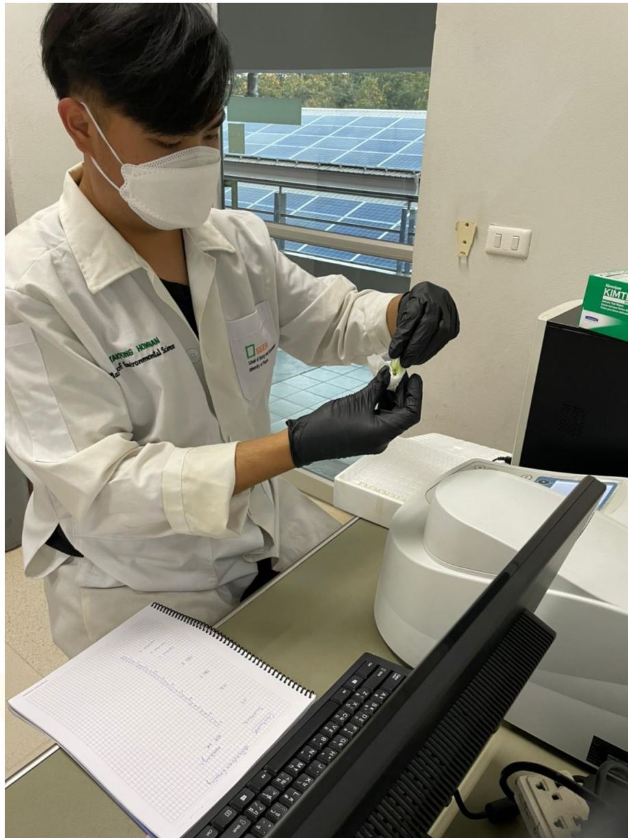
ภาพ 37 การวิเคราะห์ปริมาณคอโรฟิลล์ เอ ของสาหร่าย S. platensis
