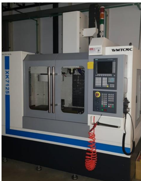
ภาพ 2 แสดงตัวอย่างเครื่องซีเอ็นซีกัด 3 แกน (CNC Milling 3 – axis)
