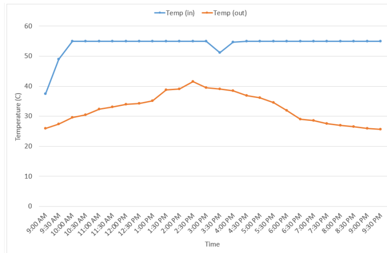
ภาพ 43 ผลต่างอุณหภูมิภายนอกกับภายในตู้อบแห้งที่ใช้ระบบไมโครคอนโทรลเลอร์ ในการควบคุมระบบอบแห้งอัจฉริยะ (Smart Solar Drying)
