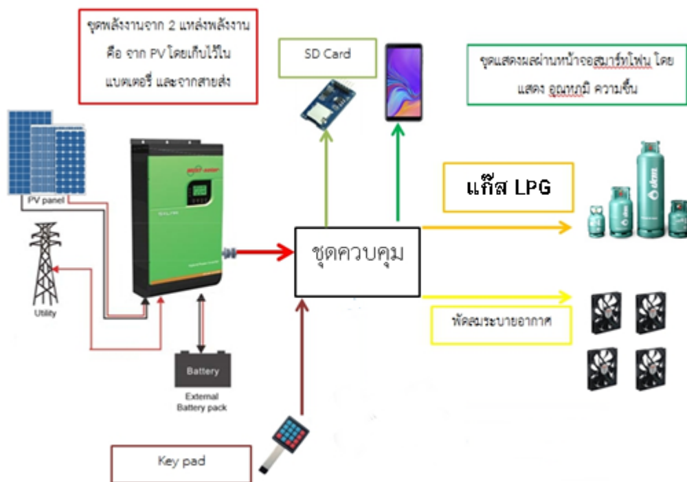
ภาพ 34 การออกแบบระบบควบคุมระบบอบแห้งอัจฉริยะ (Smart Solar Drying)
