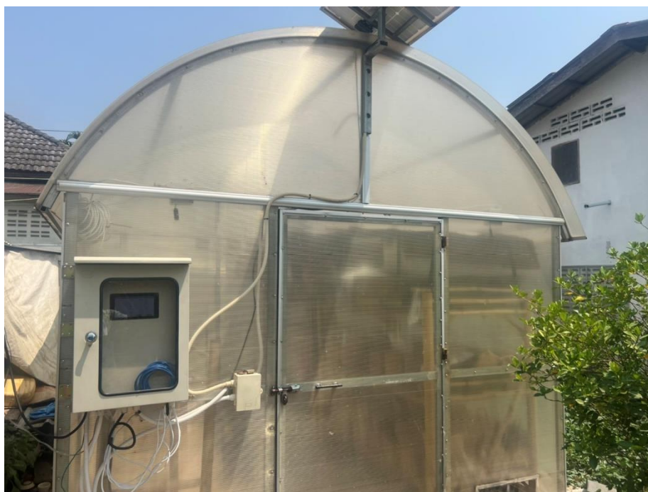
ภาพ 29 เครื่องอบแห้งพลังงานแสงอาทิตย์ที่ติดตั้งระบบตรวจวัด
