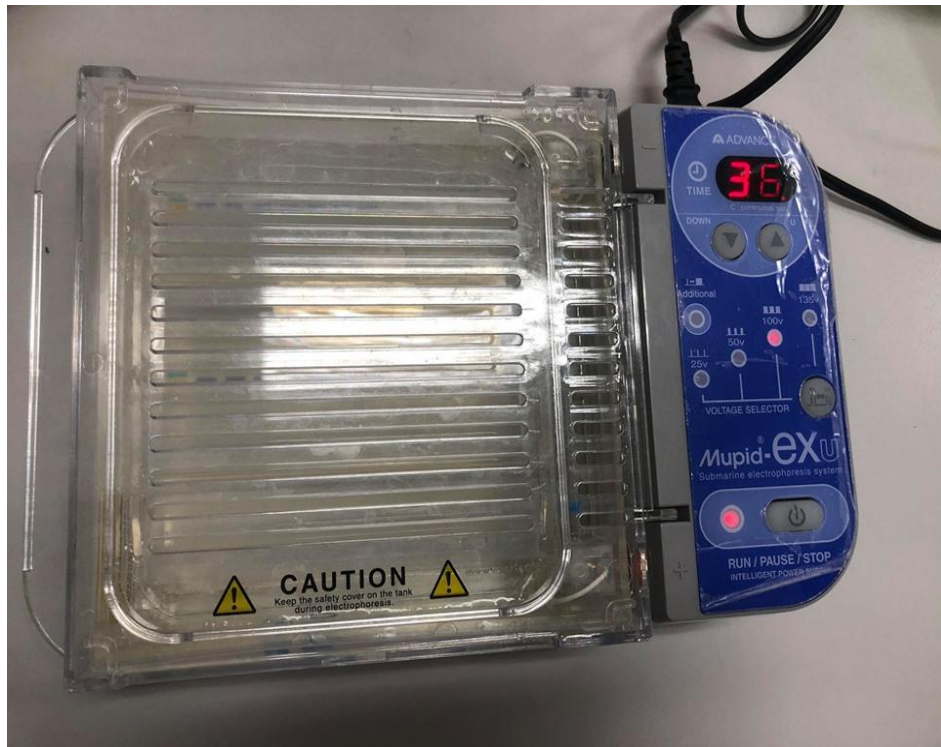
เครื่องอิเล็กโทรโฟรีซิส (Electrophoresis)
