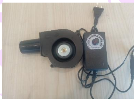
รูปที่ 31 เครื่องอัดอากาศ
