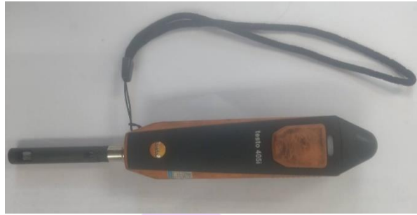
รูปที่ 32 เครื่องวัดความเร็วลม testo 405i
