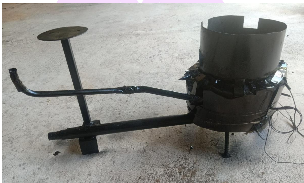
รูปที่ 25 ลักษณะหัวเผาวัสดุพูนที่ใช้ในการทดลอง
