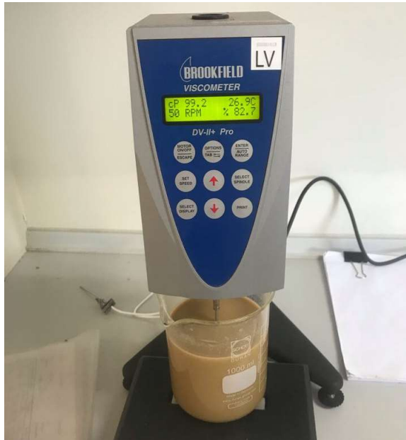
ภาพ 38 แสดงค่าความหนืดของผงอินนูลินที่สกัดได้ ซ้ำ 1 มีค่าเท่ากับ 99.2 cP
