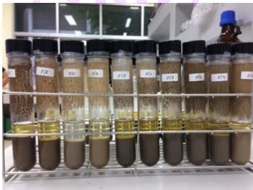
ภาพ 17 การแยกชั้นตกตะกอนของตัวอย่างมูลสัตว์และดิน
