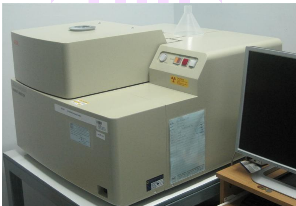
ภาพ 53 เครื่องมือการทดสอบโดยวิธีเอกซเรย์ฟลูออเรสเซนซ์
