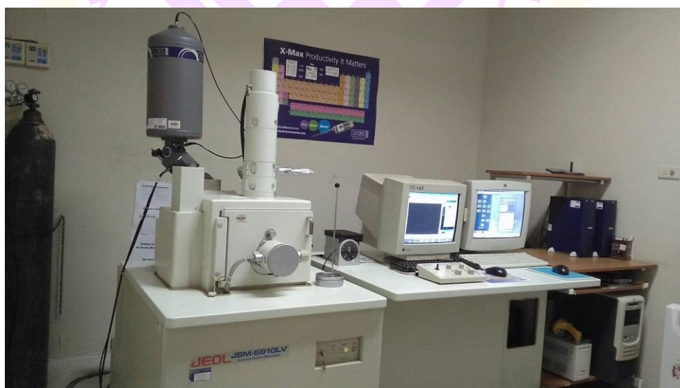
ภาพ 54 เครื่องมือการทดสอบโดยกล้องอิเล็กตรอนแบบส่องกราด
