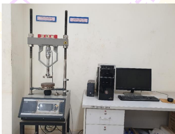
ภาพ 55 เครื่องทดสอบกำลังรับแรงอัดแกนเดียว
