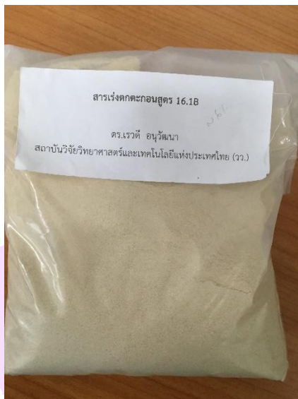
ภาพ 12 ลักษณะทางกายภาพของสาร PAFSiC ได้รับการสังเคราะห์มาจากถ่านหินจากโรงไฟฟ้าแม่เมาะ จังหวัดลำปาง
