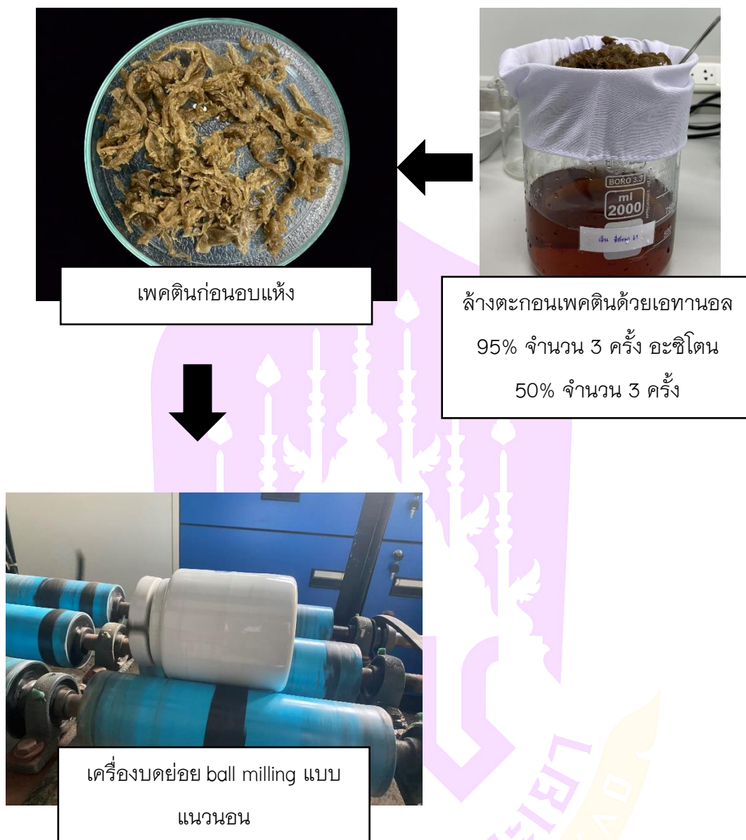
ภาพ 24 ขั้นตอนการเตรียมการสกัดเพคตินจากใบกรุงเขมา
