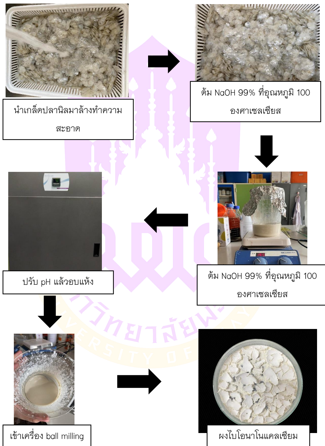
ภาพ 26 การสังเคราะห์ไบโอไนโนแคลเซียมจากเกล็ดปลานิล
