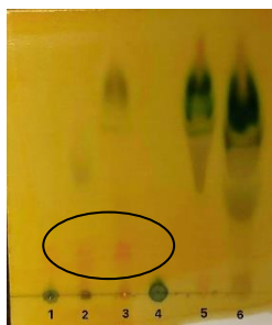
ภาพ 14 การทดสอบแอลคาลอยด์ด้วยสารละลาย Dragendorff's reagent โดยเทคนิค TLC
