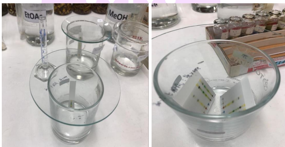
ภาพ 37 การนำแผ่น TLC จุ่มในตัวทำละลาย เพื่อให้ตัวทำละลายพาสารเคลื่อนที่
