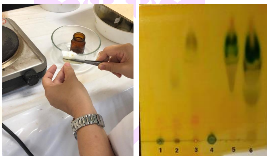
ภาพ 40 การย้อมแผ่น TLC ด้วยสารละลาย Dragendorff's reagent
