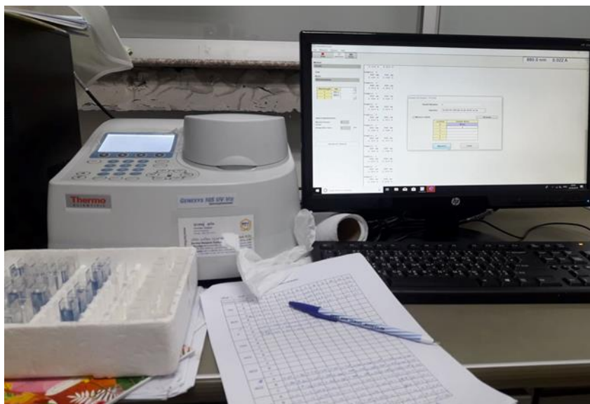
ภาพ 45 การวิเคราะห์ปริมาณรงควัตถุโดยวัดค่าการดูดกลืนแสงที่ความยาวคลื่นต่าง ๆ
